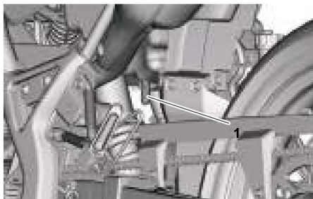
1. Mangueira de verificação do filtro de ar
