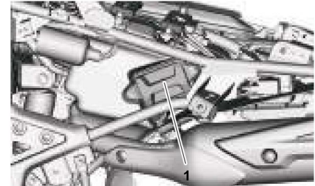
1. Tampa da caixa do filtro de ar
