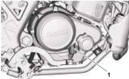
1. Tampa de enchimento de óleo do motor
