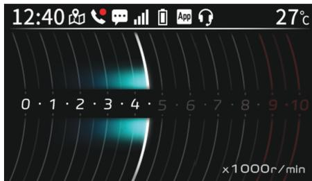
O visualizador do taquímetro mostra a velocidade do motor, conforme medida para velocidade de rotação da cambota, em rotações por minuto (rpm).
