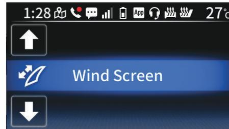
Este módulo permite controlar o para-brisas. Mantenha os interruptores “^”/“v” premidos para ajustar a posição do para-brisas para cima/baixo.
