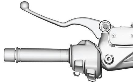
Os pontos de articulação das alavancas dos travões dianteiro e traseiro devem ser lubrificados nos intervalos especificados na
