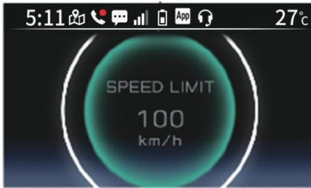
O limite de velocidade da estrada em que se encontra atualmente é indicado por texto e por um círculo externo. O círculo interno aumenta/diminui para indicar a velocidade atual do veículo. Quando o limite de velocidade é atingido/ultrapassado, o círculo externo muda de cor para laranja.
