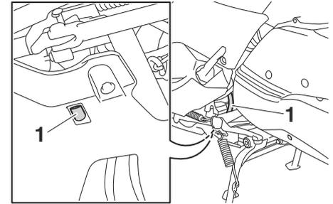
1. Tubo de descarga do depósito de combustível
