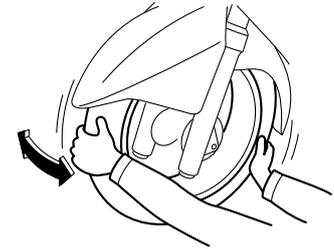
Os rolamentos de roda dianteiros e traseiros têm de ser verificados nos intervalos de tempo especificados na tabela de lubrificação e manutenção periódica. Se houver uma folga no cubo da roda ou se a roda não virar suavemente, solicite a um concessionário Yamaha que verifique os rolamentos de roda.
