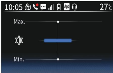
O indicador multifunções está equipado com um sensor para detetar as condições de iluminação ambiente e ajustar os níveis de luminosidade dos visores. Este módulo também permite definir manualmente os níveis de luminosidade do ecrã.
