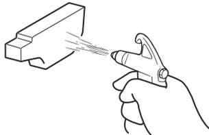
8. Verifique se existem danos no elemento do pré-filtro de ar e, caso necessário, substitua-o.
