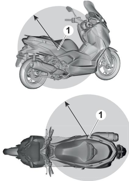
1. Antena instalada no veículo
