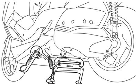
Antes de cada viagem, deverá verificar o funcionamento dos descansos central e lateral e, se necessário, deverá lubrificar os pivôs e as superfícies de contacto de metal com metal.
