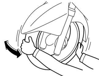
Os rolamentos de roda dianteiros e traseiros têm de ser verificados nos intervalos de tempo especificados na tabela de lubrificação e manutenção periódica. Se houver uma folga no cubo da roda ou se a roda não virar suavemente, solicite a um concessionário Yamaha que verifique os rolamentos de roda.
