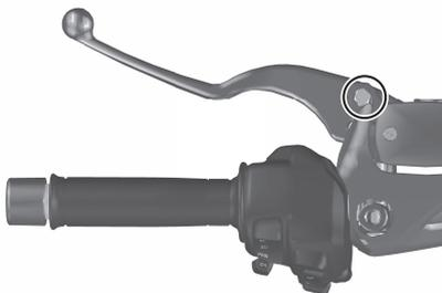
Os pontos de articulação das alavancas dos travões dianteiro e traseiro devem ser lubrificados nos intervalos especificados na tabela de lubrificação e manutenção periódica.
