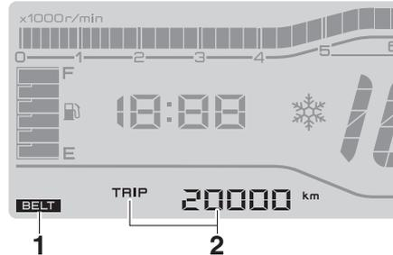
1. Indicador de substituição da correia em V “BELT”
