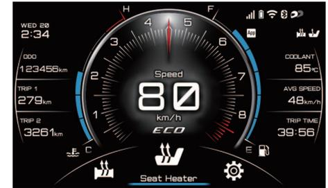
Desloque o joystick cima-baixo para alternar entre aquecedor de assento DESLIGADO e 3 predefinições que podem ser personalizadas em “Machine Settings” → “Seat Heater”. (Consulte a página 5-26.) O ícone do aquecedor de assento no canto superior direito do visor apresenta a predefinição de aquecedor de assento selecionada atualmente.
