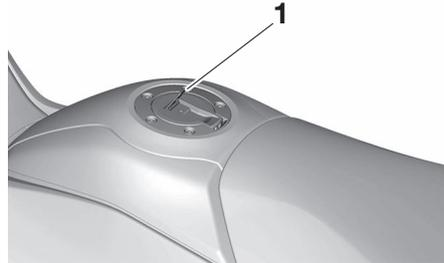
1. Trinco da tampa do depósito de combustível
