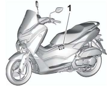
1. Antena instalada no veículo
