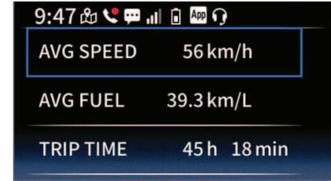
Este módulo permite a reposição dos itens do visor de informações do veículo. Prima brevemente os interruptores “^”/“v” para destacar um item. Prima brevemente o interruptor “v” para repor o item. Confirme ao selecionar “OK”.
