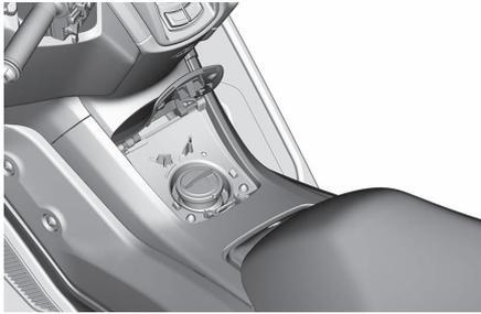
Prima o botão “FUEL” para abrir a cobertura da tampa do depósito de combustível. Após reabastecer, empurre a cobertura da tampa do depósito de combustível até fechar.
