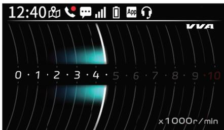
Este ecrã contém um visualizador de taquímetro, um visor do modo de condução e um visor do estado da redução de velocidade.
