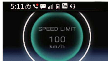
O limite de velocidade da estrada em que se encontra atualmente é indicado por texto e por um círculo externo. O círculo interno aumenta/diminui para indicar a
