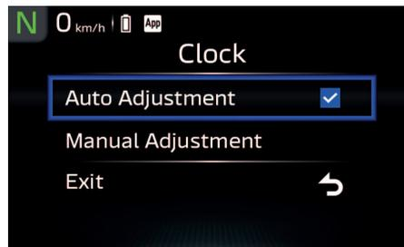
O relógio pode ser configurado para ajuste automático em sincronização com um smartphone ligado. “Auto Adjustment” ON é indicado pela marca de verificação e requer uma ligação com a aplicação MyRide. A opção “Manual Adjustment” permite que o relógio seja calibrado manualmente.
