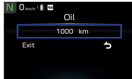
Uma vez concluída a manutenção de um dos itens, prima brevemente o botão rotativo “MENU” para o seleccionar e, em seguida, mantenha o botão rotativo “MENU” premido para o repor.
