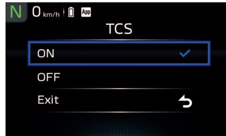
Este menu permite-lhe colocar o sistema de controlo de tração na posição “ON”/“OFF”.
