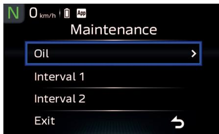
Este menu permite-lhe registar a distância percorrida entre mudanças de óleo do motor “Oil” e dois outros intervalos de manutenção à sua escolha “Interval 1”/“Interval 2”. Prima brevemente o botão rotativo “MENU” para introduzir o submenu
