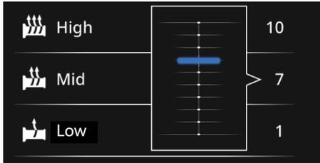
As três predefinições do aquecedor de punho podem ser personalizadas aqui. Prima brevemente “✓” para selecionar uma predefinição e, de seguida, ajuste o seu nível de calor de 1-10, deslocando o joystick no sentido cima-baixo. Prima brevemente “✓” para confirmar a definição e voltar ao menu anterior.
