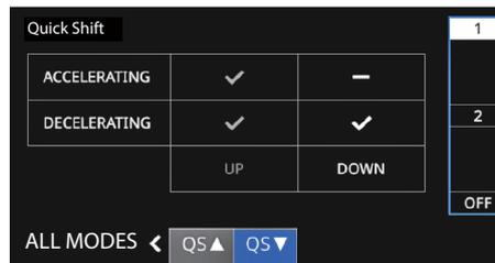
O sistema de mudança rápida de velocidade está dividido nas secções “QS  $\Delta$ ” (mudar para a velocidade seguinte) e “QS  $\nabla$ ” (mudar para a velocidade anterior). “QS  $\Delta$ ” e “QS  $\nabla$ ” não estão ligados e podem
