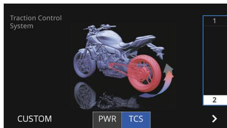
Este modelo utiliza um sistema de controlo de tração variável. Para cada nível do ponto de afinação, quanto mais inclinado estiver o veículo, mais controlo de tração (intervenção do sistema) é aplicado. Há 2 níveis de pontos de afinação disponíveis. O nível 1 aplica a menor intervenção do sistema, enquanto o nível 2 aplica o maior controlo global da tração para reduzir a derrapagem da roda traseira. (Consulte a página 3-1.)
