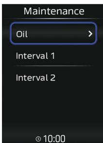
Este módulo permite-lhe registar a distância percorrida entre mudanças de óleo de motor "Oil" e dois outros intervalos de manutenção à sua escolha "Interval 1"/"Interval 2".
