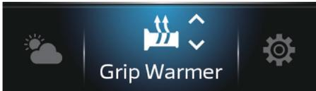
Com este item realçado, desloque o joystick cima-baixo para alternar entre o aquecedor de punho OFF e 3 predefinições.
