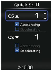
O sistema de mudança rápida de velocidade está dividido nos itens “QS ▲” (mudar para a velocidade seguinte) e “QS ▼” (mudar para a velocidade anterior). Cada item pode ser ajustado para: Desativado, 1 ou 2.
