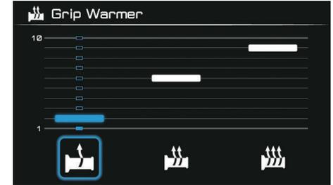
As três predefinições do aquecedor de punho podem ser personalizadas aqui. Seleccione uma predefinição deslocando o joystick esquerda-direita e ajuste o nível de aquecimento de 1-10 deslocando o joystick cima-baixo. Prima brevemente “✓” para confirmar e regressar ao menu anterior.
