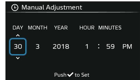
Para ajustar manualmente o relógio, realce os itens deslocando o joystick esquerda-direita. Desloque o joystick cima-baixo para
