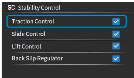
Este menu permite-lhe ativar/desativar os sistemas de controlo de estabilidade: “Traction Control” (TCS), “Slide Control” (SCS), “Lift Control” (LIF), e “Back Slip Regulator” (BSR). (Consulte a página 3-5.)
