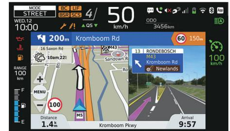
Este veículo está equipado com um sistema de navegação, que fornece orientação rodoviária visual e sonora (é necessário auricular Bluetooth). Para utilizar o sistema de navegação, primeiro deve transferir a aplicação Garmin Motorize a partir de uma loja de aplicações no seu smartphone.
