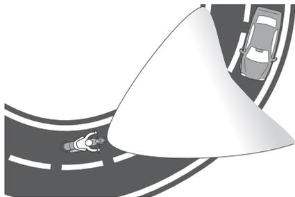
Prima sem soltar o interruptor dos faróis dianteiros na direção exterior para ligar a função dos máximos adaptáveis e o indicador dos máximos adaptáveis “A” acende-se a verde.
